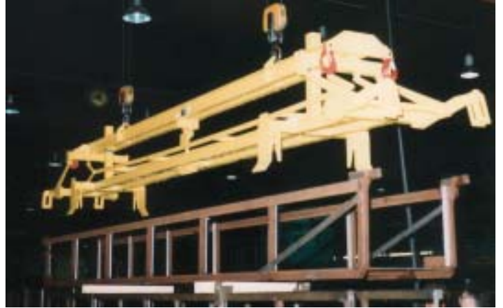
Gestellgreifer mit Aufsetzautomatik für stirnseitige Aufnahme von stapelbaren Gestellen
