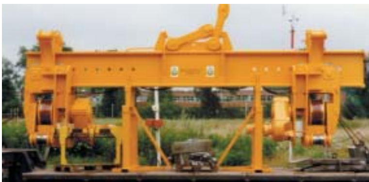
Elektromotorische Wendetraversen mit Rasterverstellung und Doppelhaken-Kraufhängung
