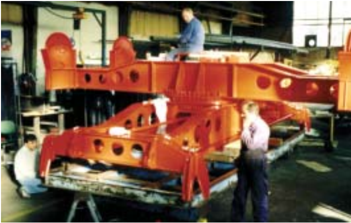
Containerspreader mit elektomotorischem Drehkranz
