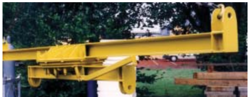
Drehtraverse mit Feststellvorrichtung
