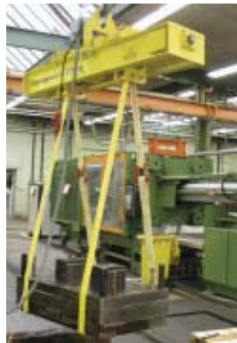
Elektromotorische Wendetraverse mit automatischem Gewichtsausgleich. Die Verstellung erfolgt über eine Rollenkette.
