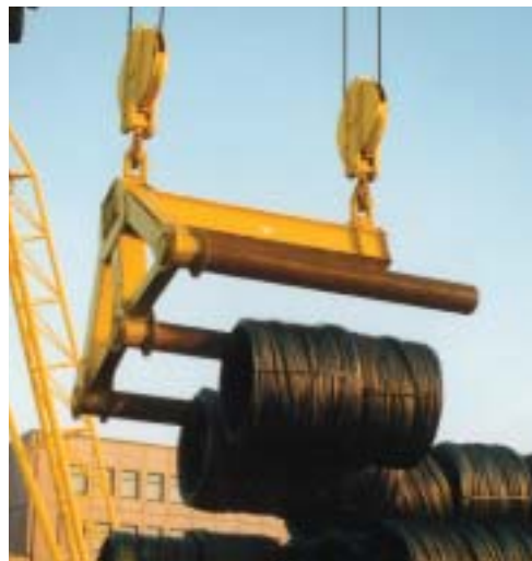
3-armiger-C-Haken zur Aufnahme von Drahtcoils
