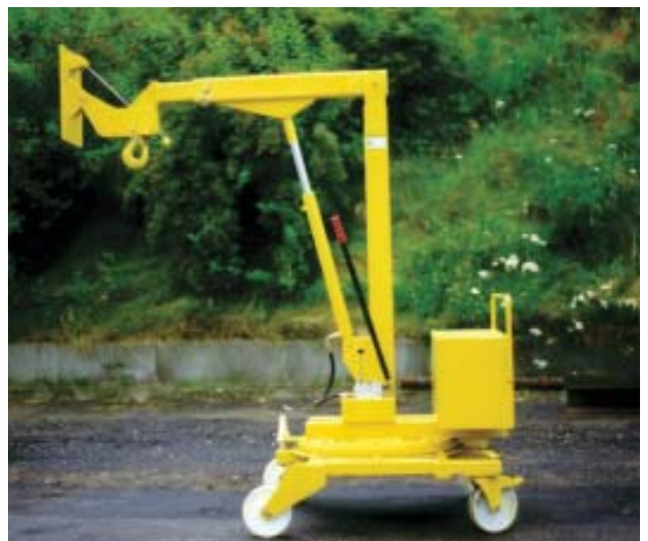
Drehbarer Gegengewichtskran, handverfahbar, geeignet für besonders enge Räume
