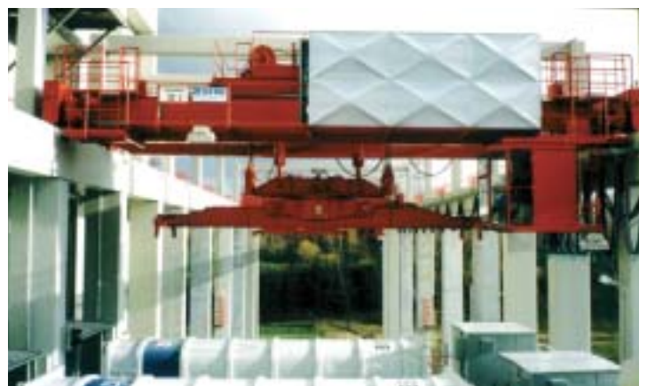
Containerspreader mit elektomotorischem Drehkranz
