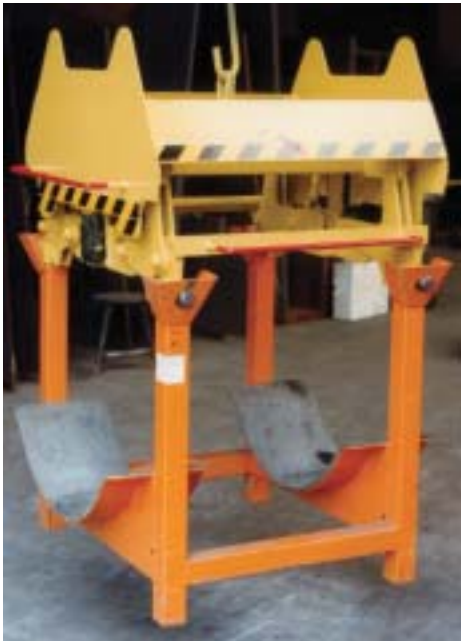
Gestellgreifer mit manueller Aufsetzautomatik
