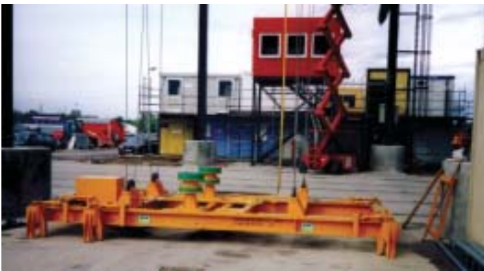
Containerspreader mit 4-Seilaufhängung und Kranpositionierung
