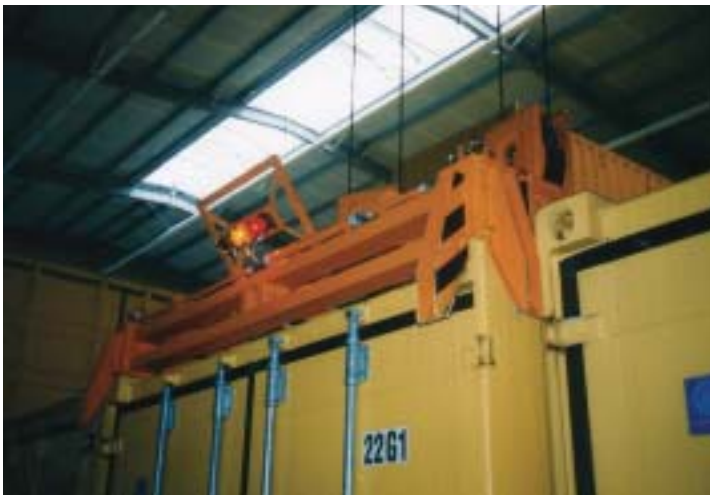
Elektrohydraulischer Containerspreader für 20' ISO-Container und Wechselaufbauten
