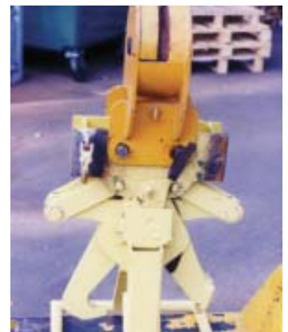
Sonderzange mit Aufsetzautomatik
