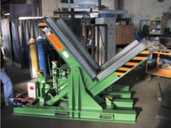
Elektrohydraulische Hub-Dreheinrichtung zum Wenden und Heben von Drahtcoils
