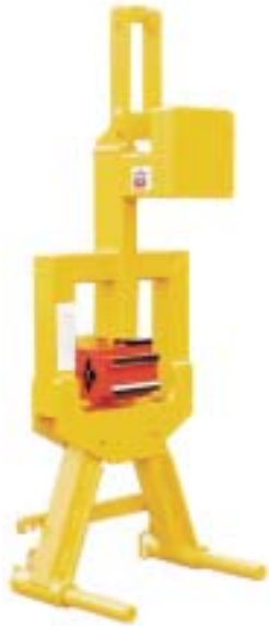
Verstellbare Anschlagdorne mit Gewichtsausgleich und zusätzlicher Permanentmagnethalterung
