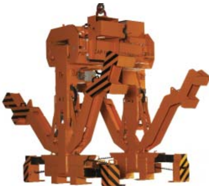
Elektromotorischer Teleskop-Blechkpaketgreifer mit feststehenden mittigen Greiferfüßen und mit zusätzlichen manuell ausziehbaren Greiferfüßen und elektrohydraulisch ausschwenkbaren äußeren Greiferfüßen
