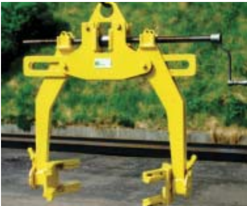
Spindelgreifer mit drehbaren Greifbacken in 90°-Raster
