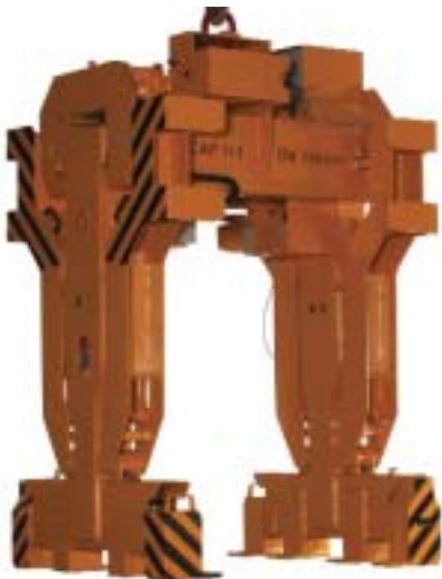
Elektromotorischer Teleskop-Blechkpaketgreifer mit feststehenden mittigen Greiferfüßen und mit zusätzlichen manuell ausziehbaren Greiferfüßen und elektrohydraulisch ausschwenkbaren äußeren Greiferfüßen
