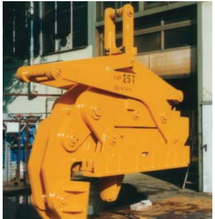
Vertikalcoilzange mit Schutzschlitten
