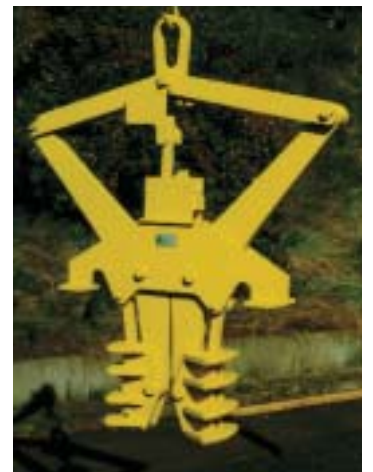
Drahtcoilinnenzange für lose Drahtbunde
