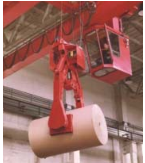
Elektrohydraulischer Papierrollengreifer mit 90° Schwenkwerk
