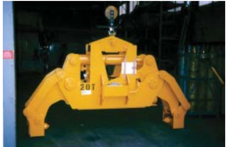
Elektrohydraulische Parallelogramm-Blockzange zum Aufrichten und Umlegen von Aluminiumblöcken
