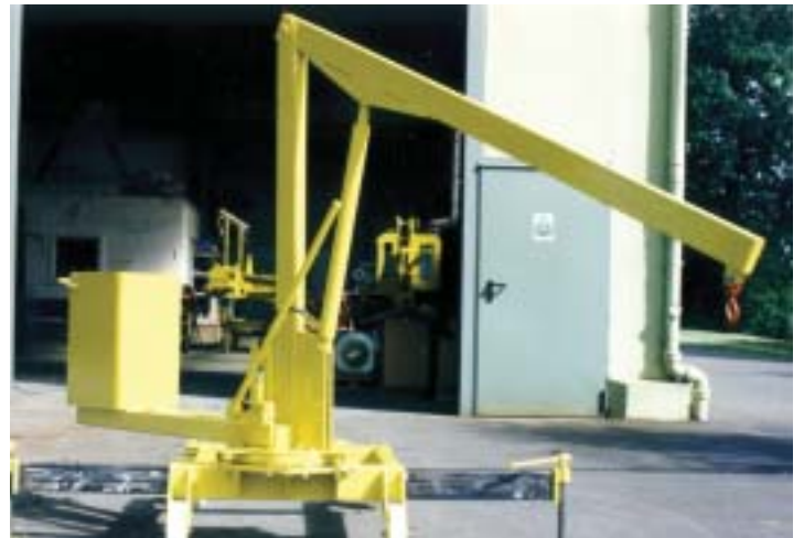
Handverfahrebarer drehbarer Kontergewichtskran mit Stützausleger
