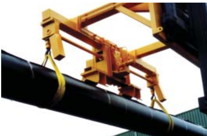
Sondertraverse mit hydraulischen Kettenhubsystem als Stapler-Anbaugerät
