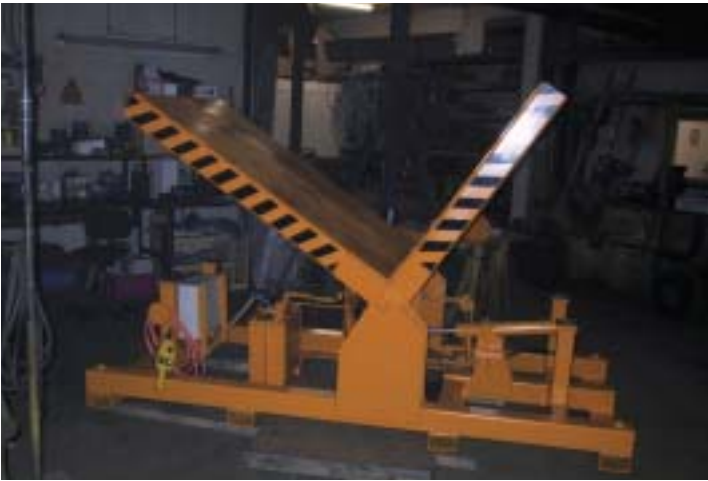
Elektrohydraulische Kipptische zum Kippen von Coils um 90° bis zu einer Tragfähigkeit von 40t
