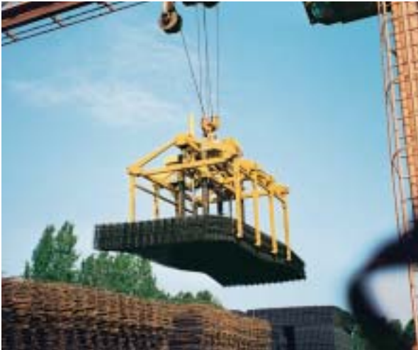
Baustahlmattengreifer - Öffnen und Schließen mechanisch, Innenhöhenverstellung elektrohydraulisch
