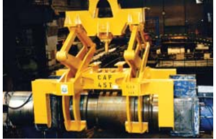
Walzentransportzange mit Aufsetzautomatik
