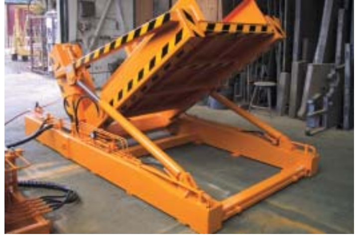
◀ Elektrohydraulischer Kipptisch mit zusätzlicher elektromotorischer Spindelverstellung als Niederhalte für Spaltcoils
