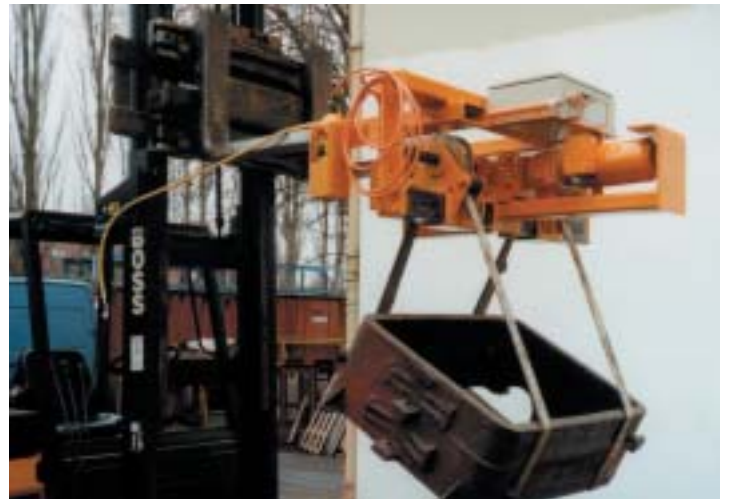
Wendetraverse als Stapleranbaugerät - Gleichstrom gespeist an der Anlasserbatterie
