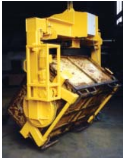
Elektromotorischer/Elektrohydraulischer Schrottkübelgreifer zum Ausschütten
