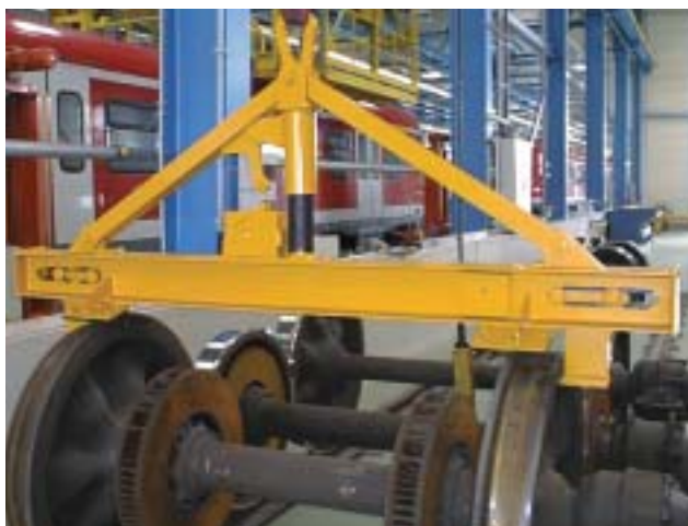
Greifertraverse mit Schaltautomatik zum Anschlagen von ICE-Radsätzen
