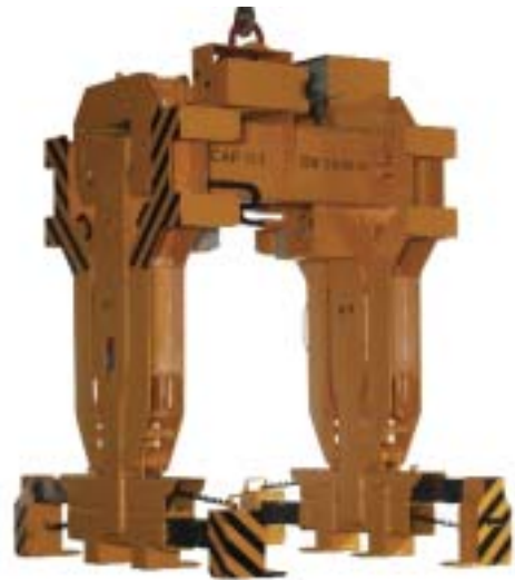
Elektromotorischer Teleskop-Blechkpaketgreifer mit feststehenden mittigen Greiferfüßen und mit zusätzlichen manuell ausziehbaren Greiferfüßen und elektrohydraulisch ausschwenkbaren äußeren Greiferfüßen
