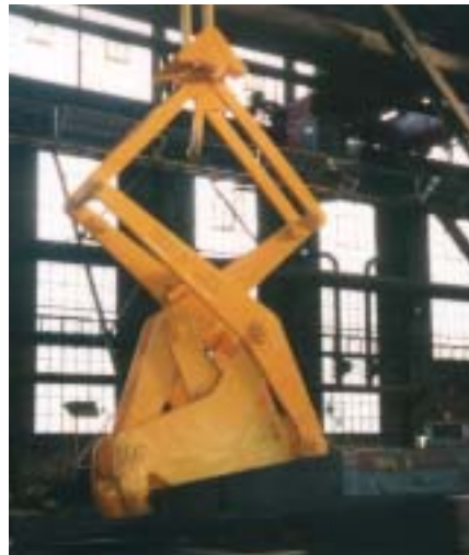
Blockzange mit Schrittschaltwerk
