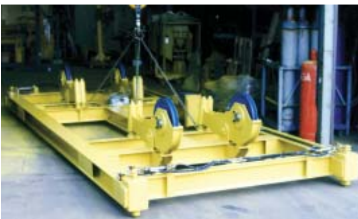
Containerspreader mit 4-Seilaufhängung und Federausgleich
