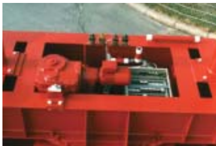
Elektronische Steuerung Container spreader mit Drehantrieb
