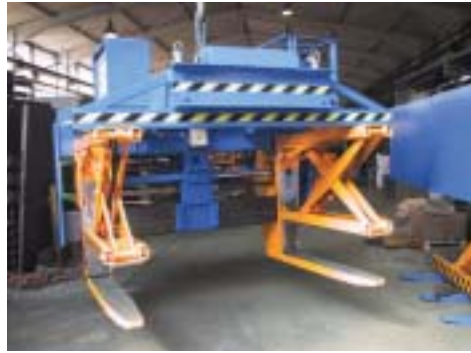
Elektrohydraulisch betätigte Plattenladegabeln mit hydraulischem Niederhalter und hydraulischer Zinkseitenverstellung.
