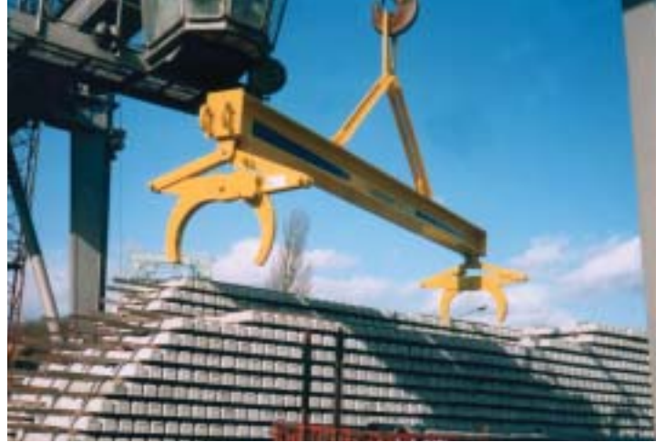
Greifertraverse zur Aufnahme von konischen Betonmasten
