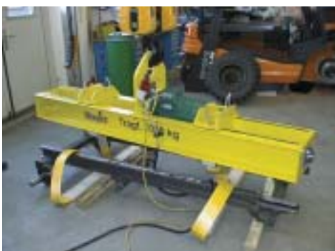
Elektromotorische Wendetraverse mit Rasterverstellung
