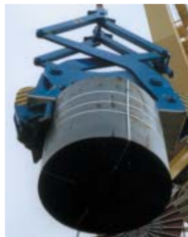
Vertikalcoilzangen mit Aufsetzautomatik und Schutzschlitten
