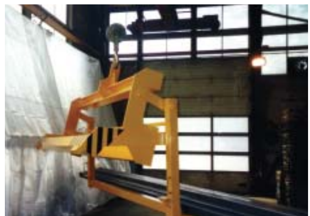
Regalbedienungsgerät mit automatisch ausschwenkbarem Kontergewicht
