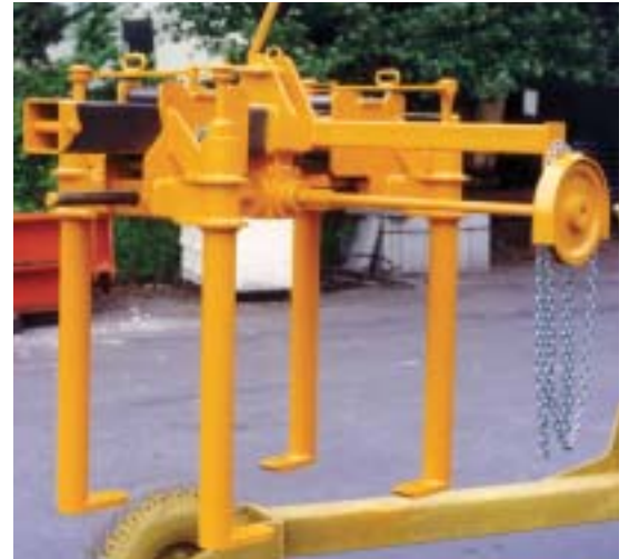
Spindelgreifer für Blechpakete mit drehbaren Greiferfüßen
