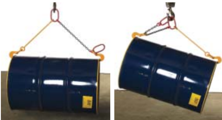
Faßgeschirr zum Aufrichten, Transportieren und Kippen von Stahlfässern
