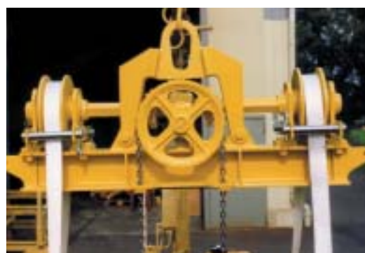
Wendetraverse mit Schneckengetriebeantrieb
