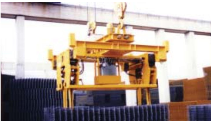
Innengreifender elektrohydraulischer Baustahlmattengreifer, die Füße sind in Breite und Längsrichtung verstellbar
