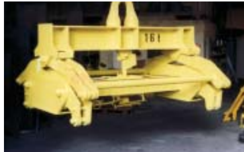
Doppelblockzange mit Aufsetzautomatik
