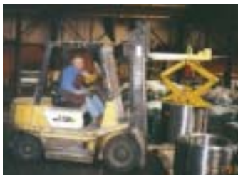
Drahtcoil-Innenzange für Staplerbetrieb
