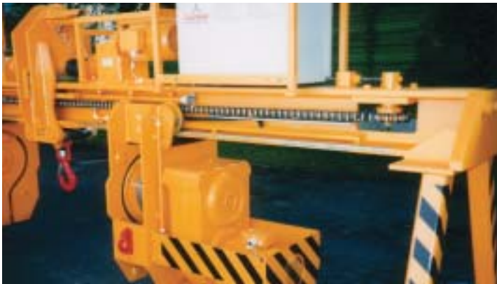
Elektromotorische Wendetraverse mit automatischem Gewichtsausgleich. Die Verstellung erfolgt über eine Rollenkette.
