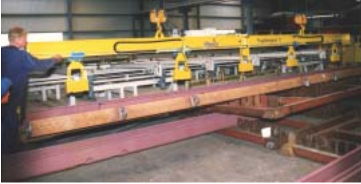
Magnettraverse zum Aufrichten von Hollandprofilen
