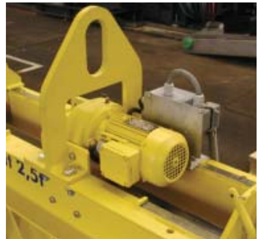
Elektromotorische Wendetraverse mit automatischem Gewichtsausgleich. Die Verstellung erfolgt über eine Rollenkette.
