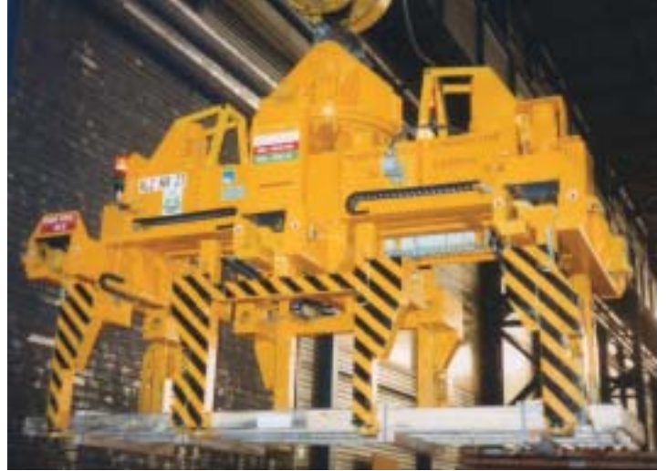
Elektrischmotorischer SPS-gesteuerter Blechpaketgreifer
