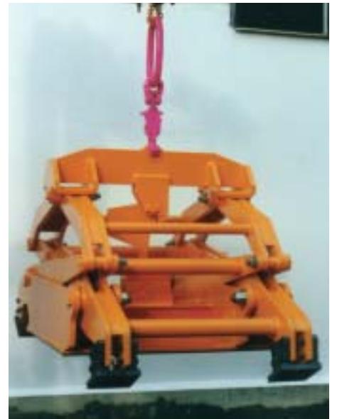
Blockzange mit Aufsetzautomatik
