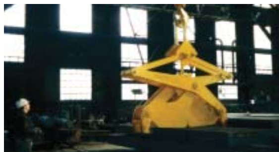
Viergelenkpunktzange in minimaler und maximaler Greifstellung
