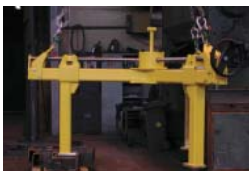
3-Arm-Spindelgreifer mit zentralem Antrieb
