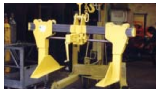
Spindelgreifer mit Wendegetriebe und Haspel- kettenrad
