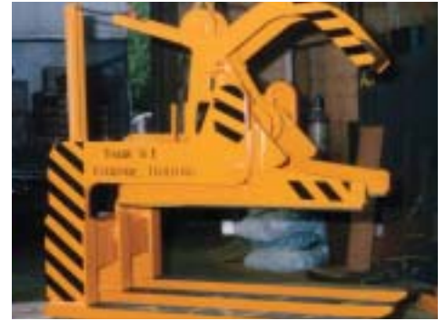
Plattenladegabel mit Niederhaltevorrichtung
