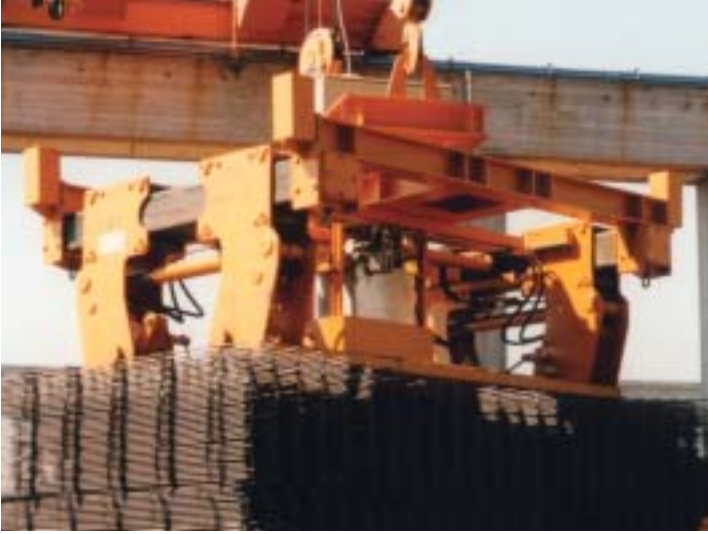
Elektrohydraulischer Baustahlmattengreifer innengreifend mit Horizontaldrehwerk mit Längs- und Querverstellbaren Greiferfüßen für die verschiedenen Mattentypen
