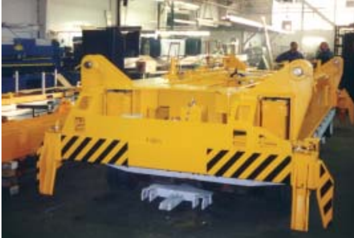
Containerspreader elektrohydraulisch teleskopierbar von 20' bis 40'
