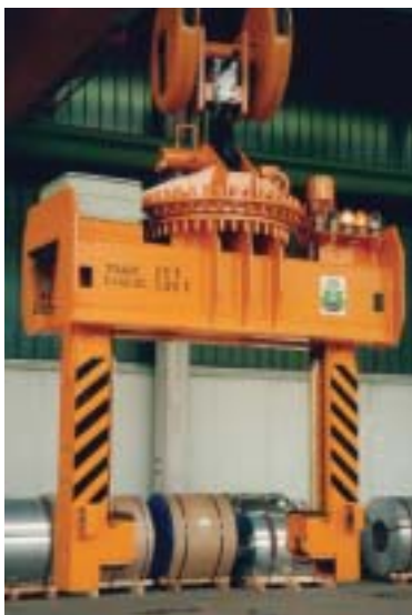
Elektromotorischer Teleskopcoilgreifer mit Horizontaldrehwerk, mit Lichtschranken zur Erfassung des Coillendurchmessers
