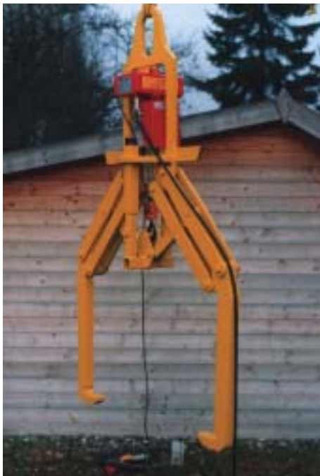
Parallelogrammgreifer das Öffnen und Schließen erfolgt über eine E-Kettenzug
