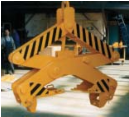
Blockzangen mit Aufsetzautomatik
