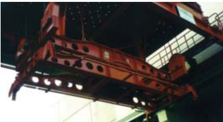
Containerspreader mit elektomotorischem Drehkranz
