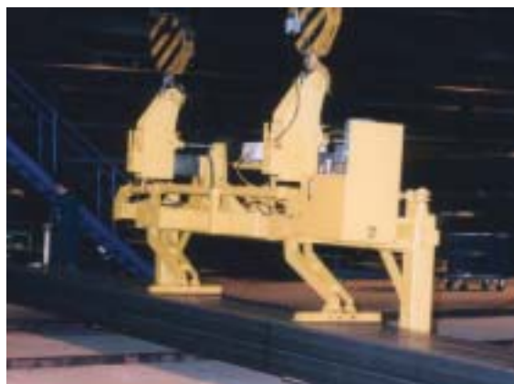
Elektrohydraulische Unterfassgabel mit Niederhaltevorrichtung und hydraulischer Schwerpunktverstellung
