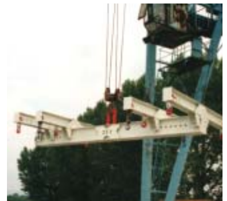
H-Traverse mit doppelten Quertraversen in Sonderlackierung
