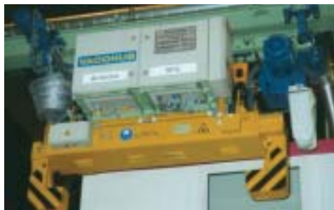
Coilgreifer vollautomatisch mit SPS-Steuerung
