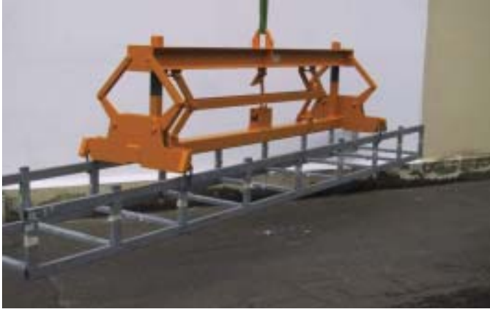
Gestellgreifer mit manueller Aufsetzautomatik
