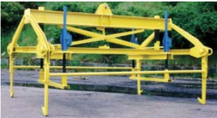
Baustahlmattengreifer mit Aufsetzautomatik und manueller Innenhöhenverstellung
