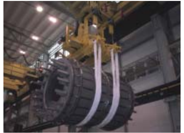
Greifertraverse zur Aufnahme von konischen Betonmasten
