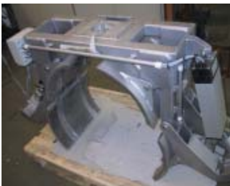
Elektromotorischer Fassgreifer in Edelstahlausführung
