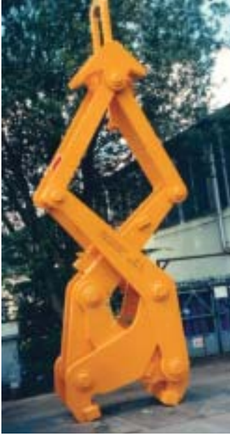
Blockzange mit Aufsetzautomatik für heiße Stahlblöcke bis zu 50t
