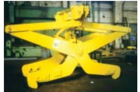
Doppelblockzange mit Aufsetzautomatik
