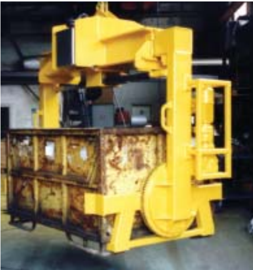
Elektromotorischer/Elektrohydraulischer Schrottkübelgreifer zum Ausschütten
