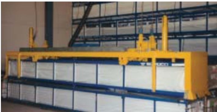
Elektromotorisch betriebter Gestellgreifer im Automatikbetrieb
