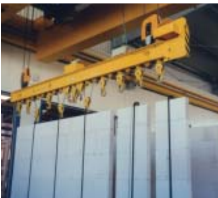
Ausgleichstraverse mit integriertem Elektorkettenzug zum Einkürzen der Ausgleichskette
