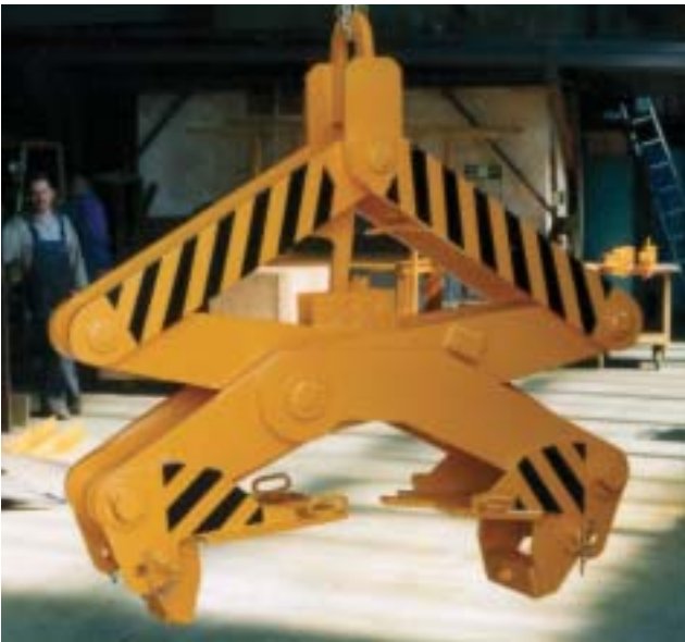
Blockzange mit Aufsetzautomatik
