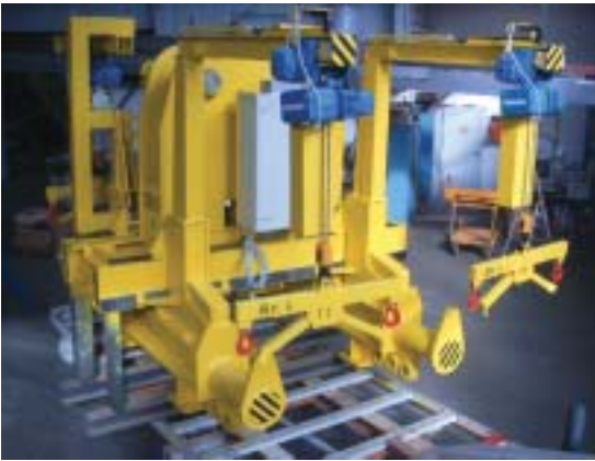
Elektromotorisch verstellbare Traverse zum Einhängen von Rundschlingen in großer Höhe
