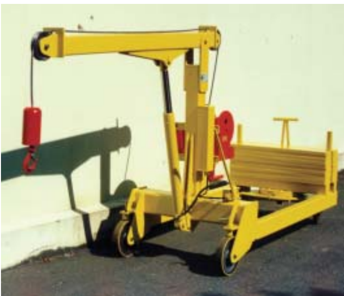
Gegengewichtskran, handverfahbar mit aufstapelbarem Gegengewicht und zusätzlicher Handseilwinde
