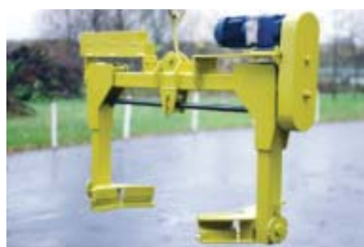
Spindelgreifer mit elektromotorischem Antrieb zum Öffnen und Schließen
