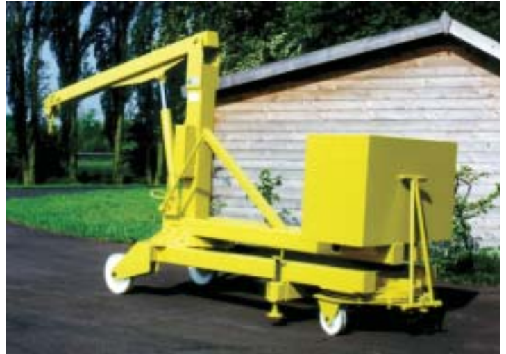
Handverfahrebarer hydraulischer Kran mit Stützausleger und als Drehkran mit drehbarem Kontergewicht
