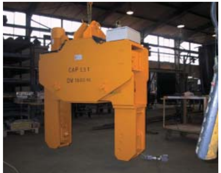
Elektromotorische Spindelzange mit Keilbackenführung
