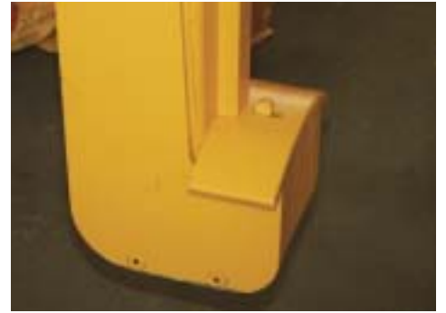
Fußkontaktleisten gegen unbeabsichtigtes Öffnen unter Last
