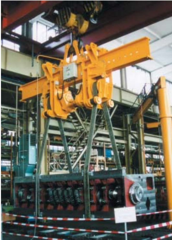
Elektromotorische Wendetraverse mit Rasterverstellung
