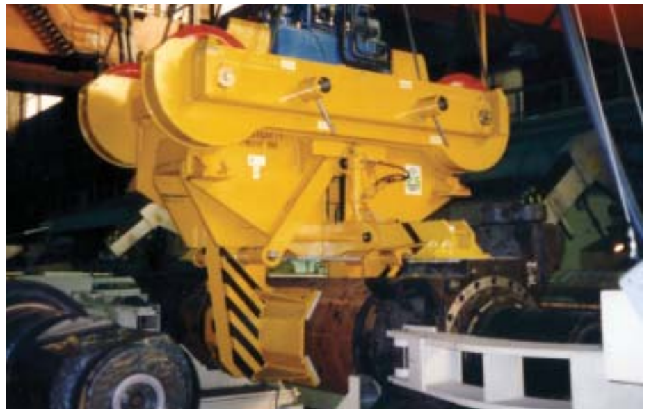
Vollautomatische elektrohydraulische Walzentransportzange
