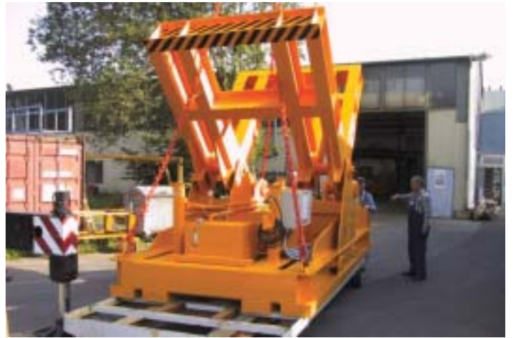
Elektrohydraulische Hub-Dreheinrichtung zum Wenden und Heben von Drahtcoils
