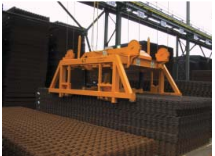
Elektrohydraulischer Baustahlmattengreifer außen greifend SPS-gesteuert mit elektromotorischer Innenhöhenverstellung, wobei bei Eingabe von Codenummern die jeweilige Öffnungsweite und Innenhöhe automatisch angefahren wird.
