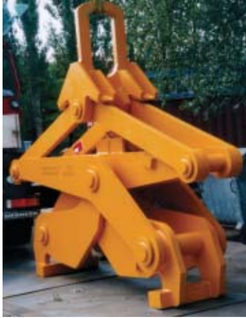
Blockzange mit Aufsetzautomatik für heiße Stahlblöcke bis zu 50t
