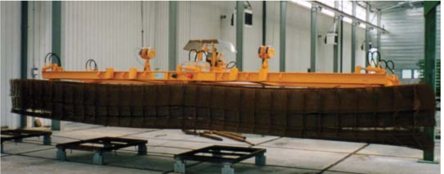
Elektrohydraulischer Baustahlmattengreifer innen greifend
