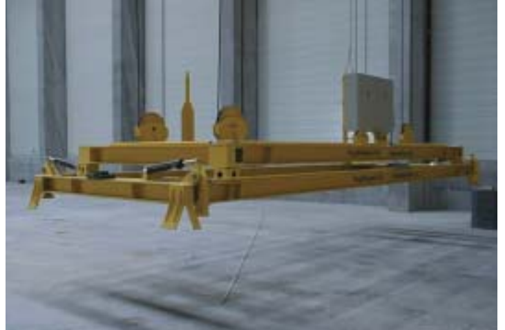
Containerspreader mit BFD-Adapter
