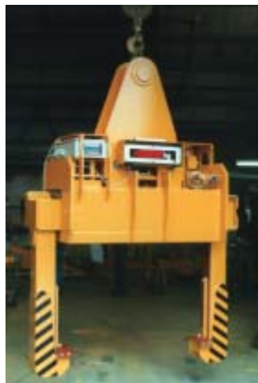
Teleskopcoilgreifer mit integrierter Wägeeinrichtung
