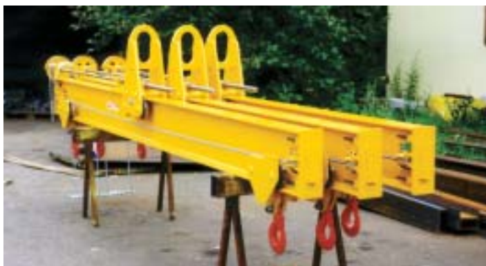
Spindeltraverse mit verstellbarem Aufhängekopf
