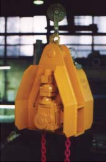
Elektromotorischer Ausgleichsblock für Schwerpunktverstellung
