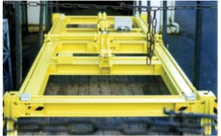
Containerspreader mit zentraler Verriegelung
