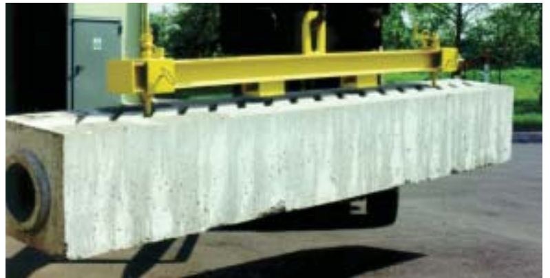
Sondertraverse mit Betonelementaufnahmezapfen
