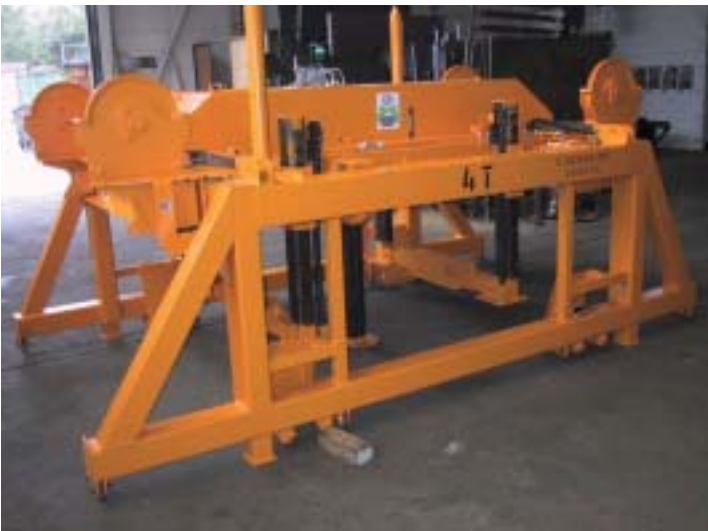
Elektrohydraulischer Baustahlmattengreifer außen greifend SPS-gesteuert mit elektromotorischer Innenhöhenverstellung, wobei bei Eingabe von Codenummern die jeweilige Öffnungsweite und Innenhöhe automatisch angefahren wird.
