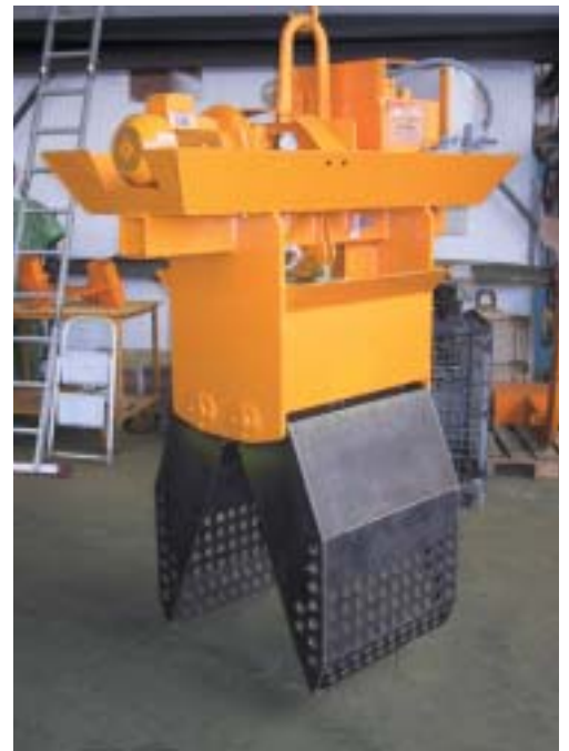
Elektrohydraulischer Schlackegreifer, gefertigt aus hitzebeständigem Stahl zum Abschöpfen von Aluminiumschlacke
