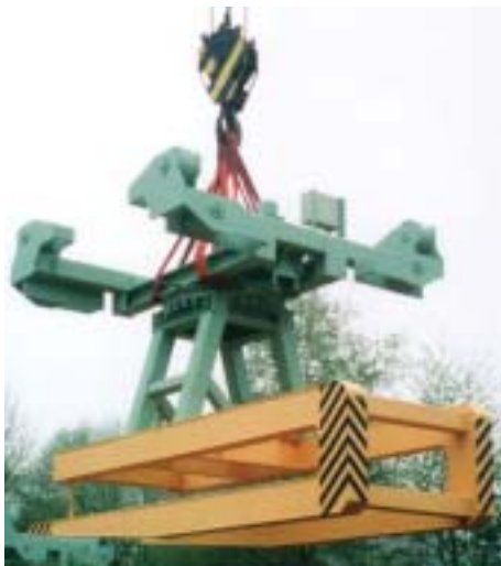
Doppel-C-Haken mit elektromotorischem Horizontaldrehantrieb und Seilrollenaufhängung
