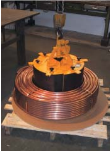
Dreiarziger vollfächiger innengreifender Backengreifer für hoch empfindliches Greifgut
