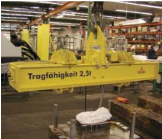
Elektromotorische Wendetraverse mit Rasterverstellung
