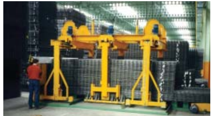
Baustahlmattengreifer - Öffnen und Schließen mechanisch, Innenhöhenverstellung elektrohydraulisch
