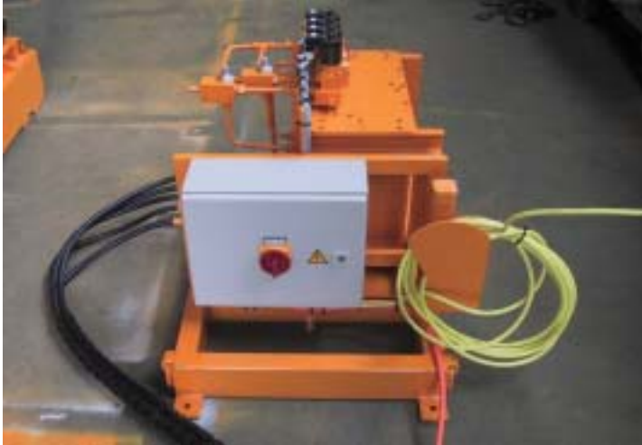
Extern aufgestelltes Pumpenaggregat für Hydraulik-Kipptisch
