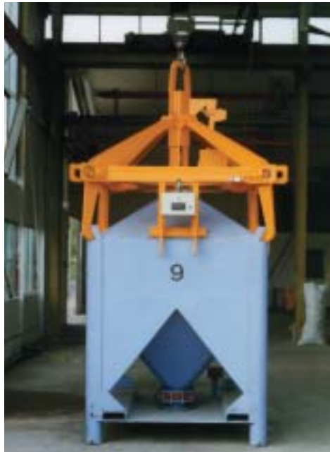
Gestellgreifer mit Schrittschaltwerk und elektronischer Überwachung der Schließung
