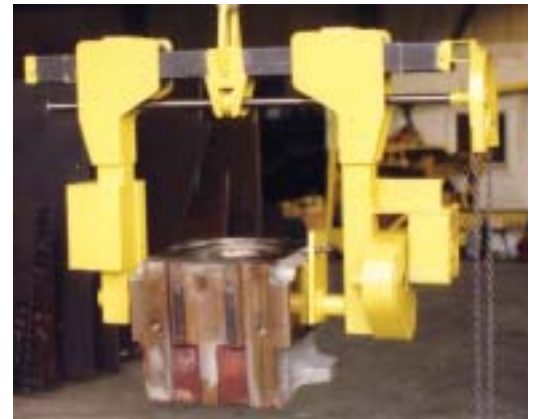
Spindelgreifer mit Wendegetriebe und Haspel- kettenrad
