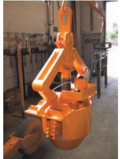
Drahtcoilinnenzange mit Elektromagnetischer Offen- und Schließautomatik
