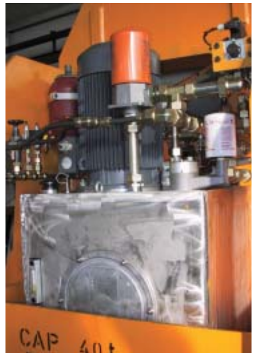
Elektrohydraulisches Pumpenaggregat mit höchstem Sicherheitsstandard für elektrohydraulische Brammen- oder Knüppelzangen mit diversen mechanischen und elektronischen Sicherheitsüberwachungen
