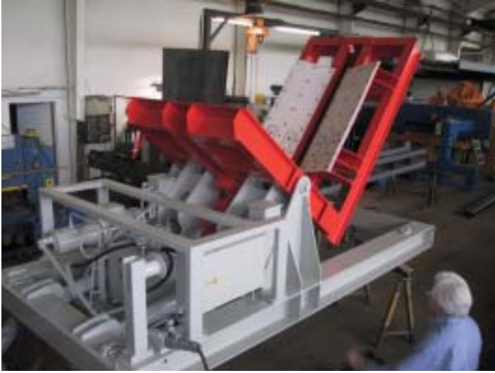
◀ Elektrohydraulischer Kipptisch mit zusätzlicher elektromotorischer Spindelverstellung als Niederhalte für Spaltcoils
