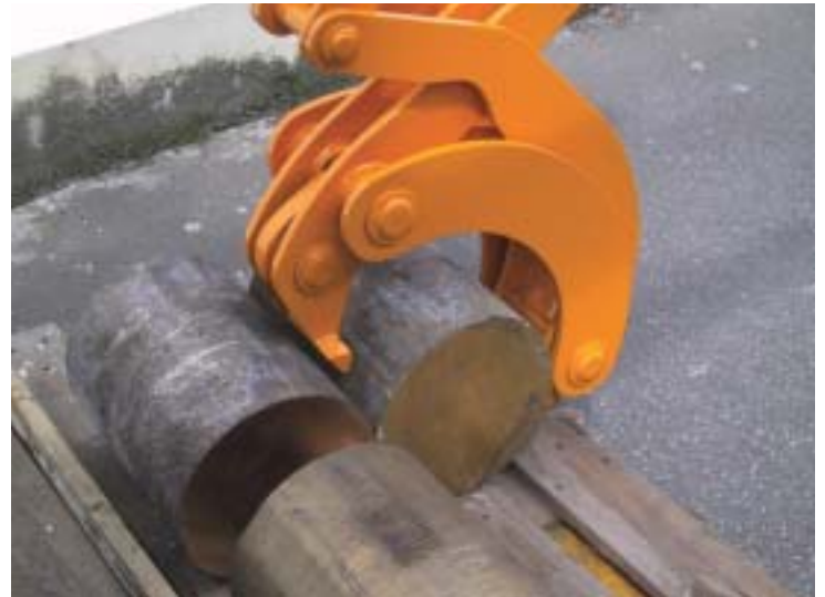
Asymmetrisch Rundgreifer für pyramidenförmig gestapeltes Rundmaterial
