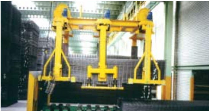
Baustahlmattengreifer mit mittiger Bundzentrierung
