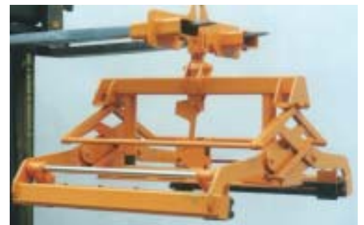
Steinpaketgreifer mit Aufsetzautomatik
