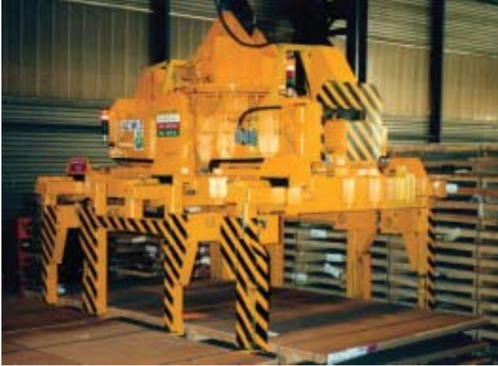
Elektrischmotorischer SPS-gesteuerter Blechpaketgreifer
