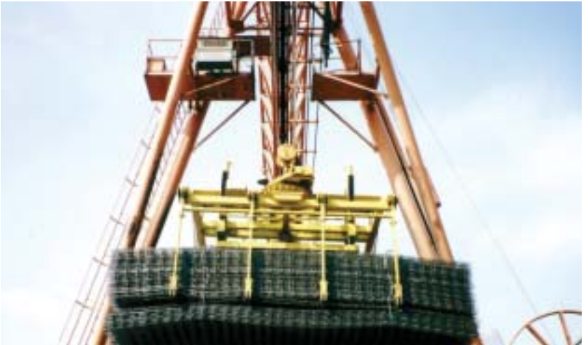
Baustahlmattengreifer - Öffnen und Schließen mechanisch, Innenhöhenverstellung elektrohydraulisch
