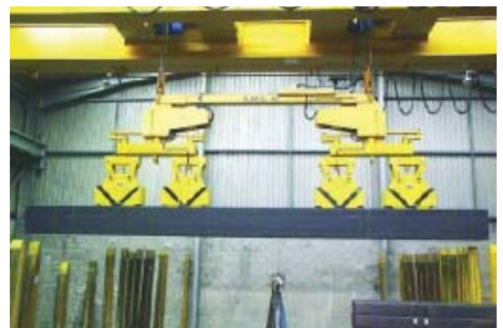
Elektromagnettraverse mit elektromotorischer Quertraversen-Verstellung (Schrägstellung) für Rohrbunde, wobei hier ein oder zwei nebeneinander liegende Rohrbunde gleichzeitig gegriffen werden können.
