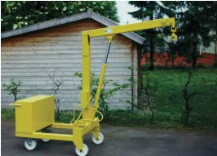
Handverfahrebarer hydraulischer Gegengewichtskran
