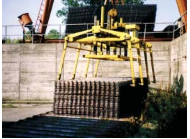
Baustahlmattengreifer mit elektrohydraulischer Innenhöhenverstellung.
