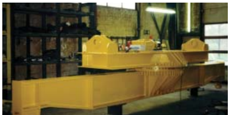
Elektromotorische Drehtraverse für 2-Kranbetrieb
