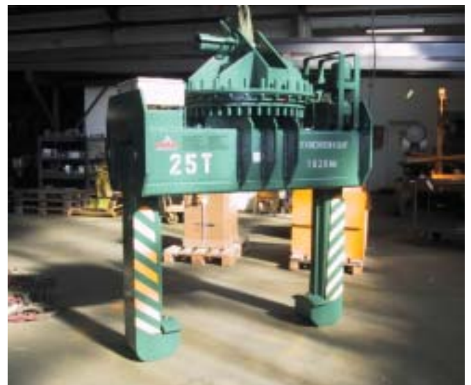
Teleskopcoilgreifer mit Drehwerk
